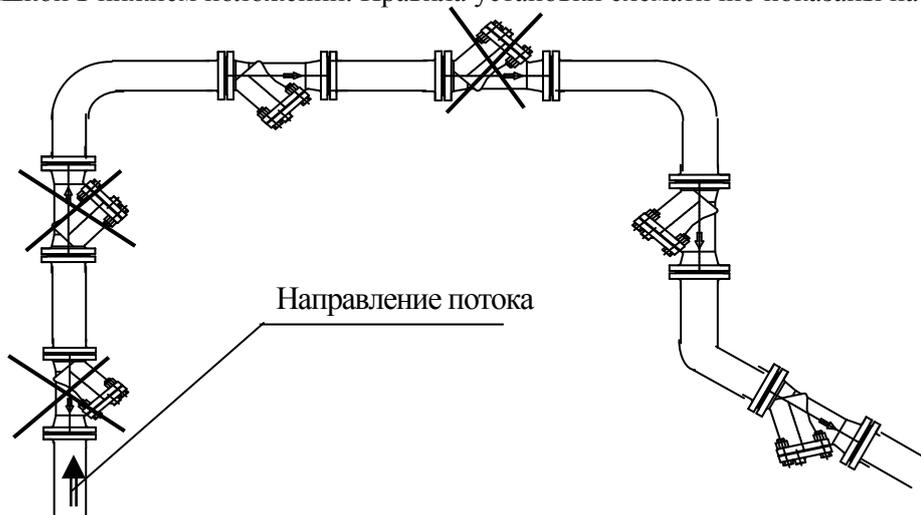
Рисунок 3. Правила установки фильтра на трубопровод
