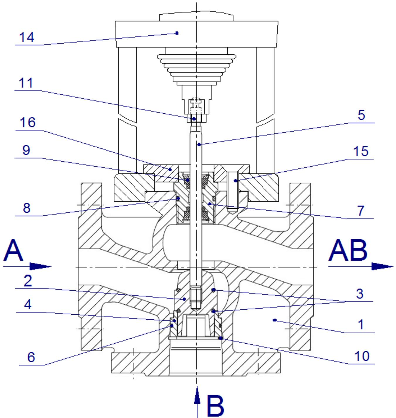
Рисунок А.2 Устройство клапана с приводом ST 0
