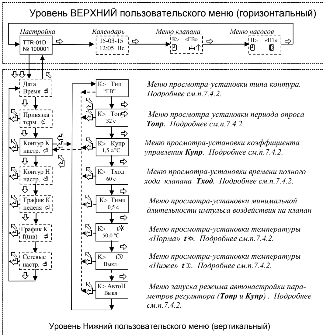
Рисунок 5 - Структура меню настройки параметров контура управления клапаном для типа контура “ГВ” (система ГВС)
