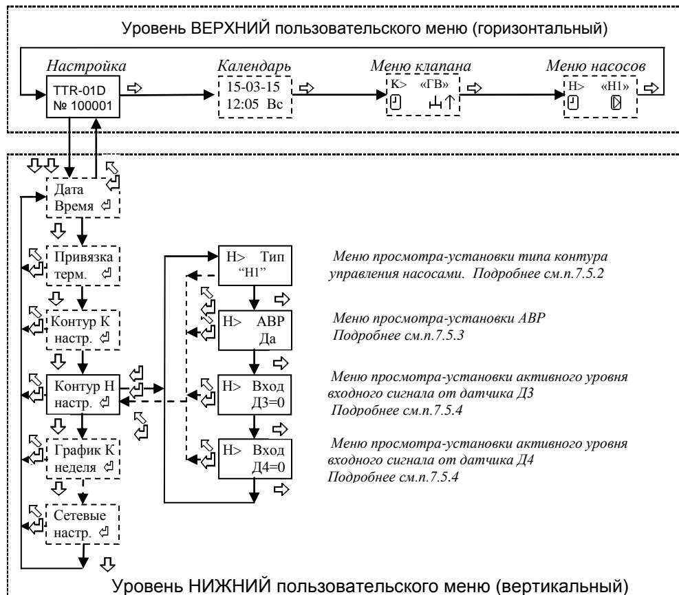
Рисунок 10 - Структура меню настройки параметров контура управления насосами.
