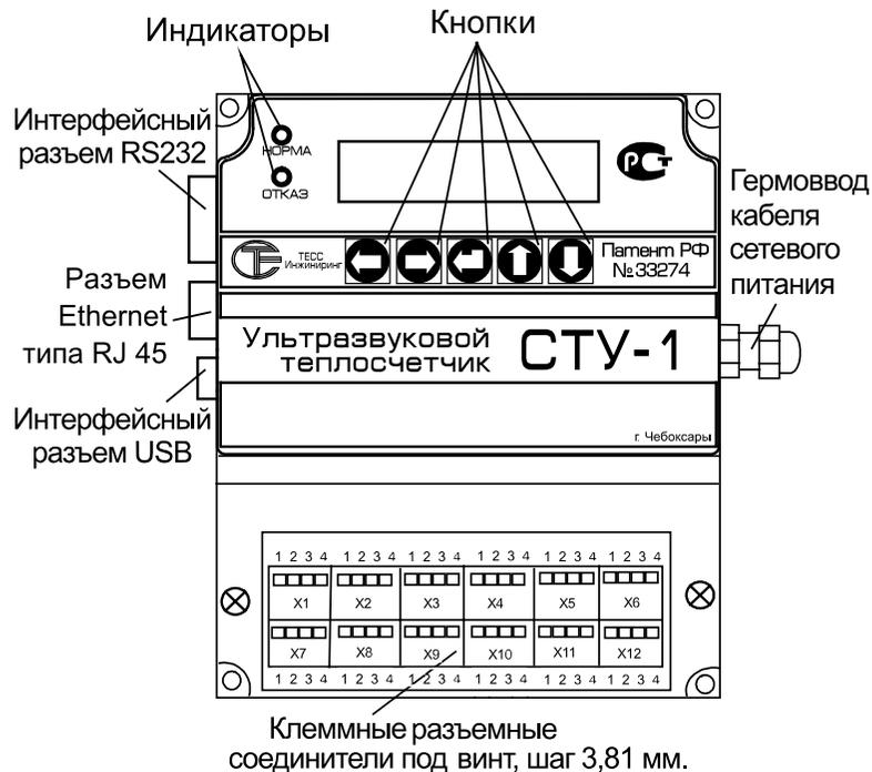
Расположение элементов управления, индикации и разъемов на корпусе теплосчетчика СТУ-1 модель 2.
