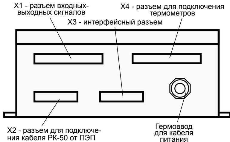
Расположение разъемов на корпусе теплосчетчика СТУ-1 модель 1
